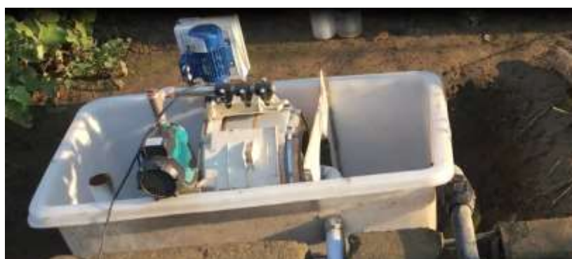
شکل ۱: قرارگیری دستگاه ساخته شده در مسیر پساب خروجی از استخرهای پرورش ماهی قزل‌آلا Figure 1: Placement of drum filter in the effluent from trout farming ponds
